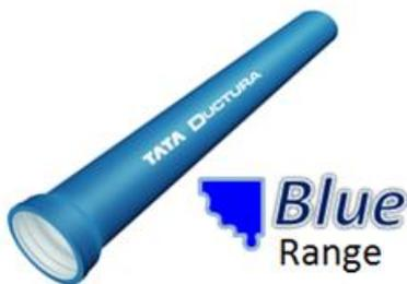
Tuyau **Blue Range** pour l'adduction ADD, K9, C25 à C100 avec revêtement intérieur en mortier de ciment de haut-fourneau. Revêtement extérieur avec 200 gr/m<sup>2</sup> ou 400 gr/m<sup>2</sup> de zinc pur ou de zinc aluminium, recouvert de résine époxy bleue à raison de 70 µm (microns).
