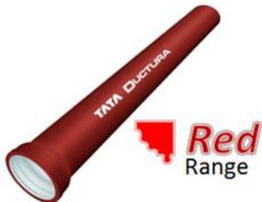
Tuyau **Red Range** pour l'assainissement ASS avec revêtement intérieur en mortier de ciment alumineux. Revêtement extérieur avec 200 gr/m<sup>2</sup> de zinc pur ou de zinc aluminium, recouvert de résine époxy rouge à raison de 70 µm (microns).
