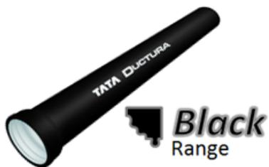
Tuyau **Black Range** pour l'adduction ADD, K9, C25 à C100 avec revêtement intérieur en mortier de ciment de haut-fourneau. Revêtement extérieur avec 200 gr/m<sup>2</sup> de zinc filé à chaud, recouvert de bitume noir à raison de 70 µm (microns).
