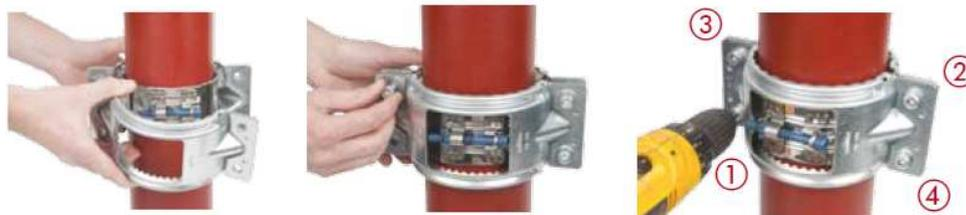
1. Les segments à griffes doivent uniformément entourer les connecteurs de base. Par conséquent, visser tout d'abord légèrement les segments ensemble et veiller à ce que les inserts à griffes ne soient pas en contact avec le collier métallique du joint.
