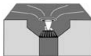
Dacheinlauf für Aquaperfect Druckströmungssystem mit Luftsieb bei Erreichen der Berechnungsregenspende
