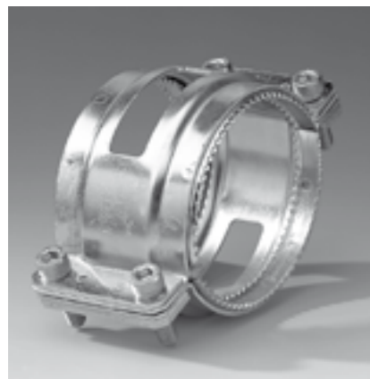
Rekord-Kralle Längskraftschlüssige Sicherungsschelle für Rapid-Verbindungen über 0,5 bar Innendruck
