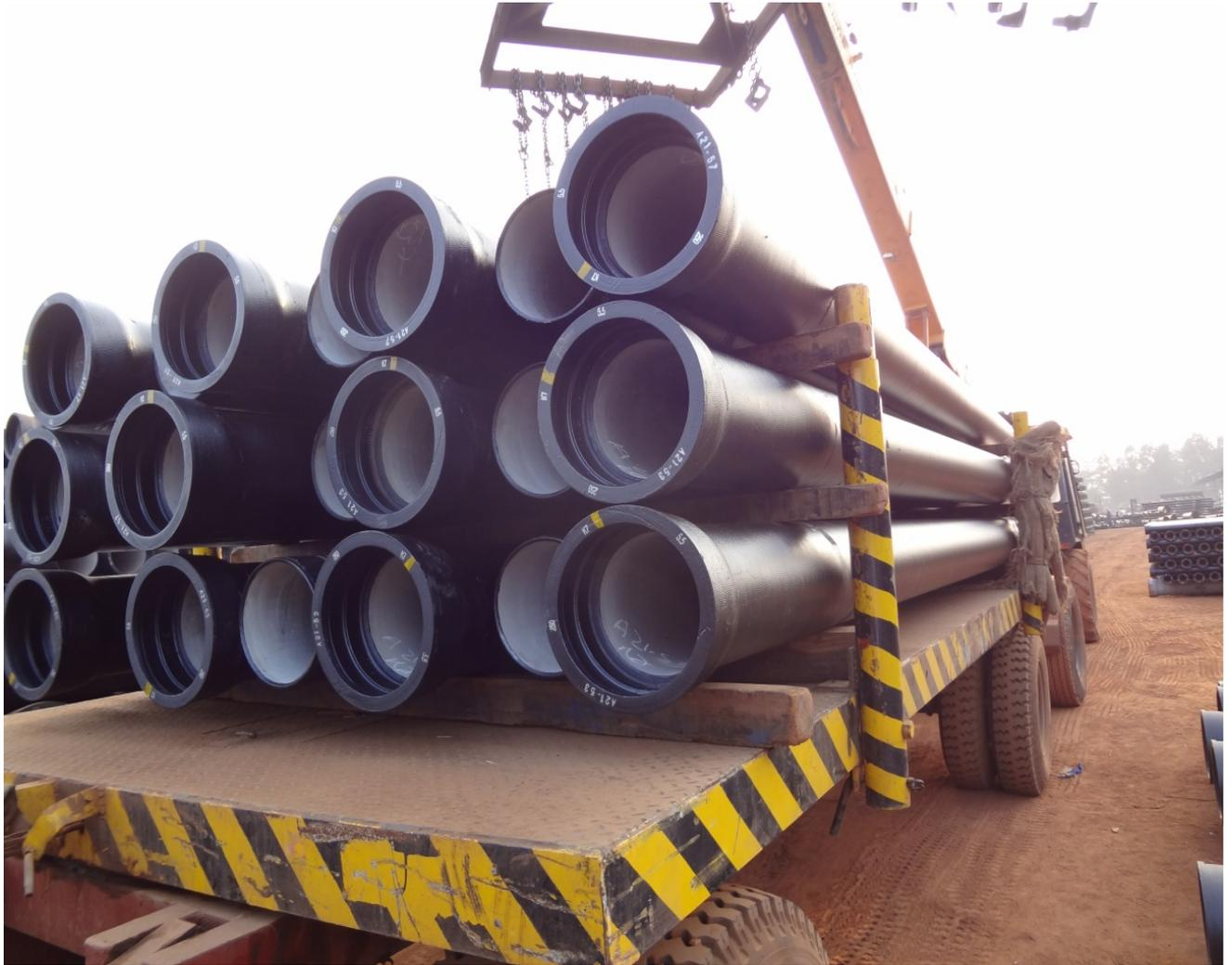
Chantier Sénégal : tuyaux K9, 12000 mt DN 400 & 500 mm (AEP)
