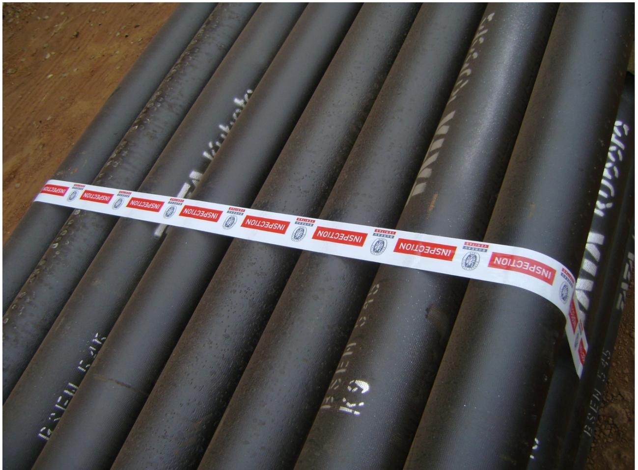
Chantier Mali : tuyaux K9, 6000 mt DN 100 à DN 300 mm (AEP)
