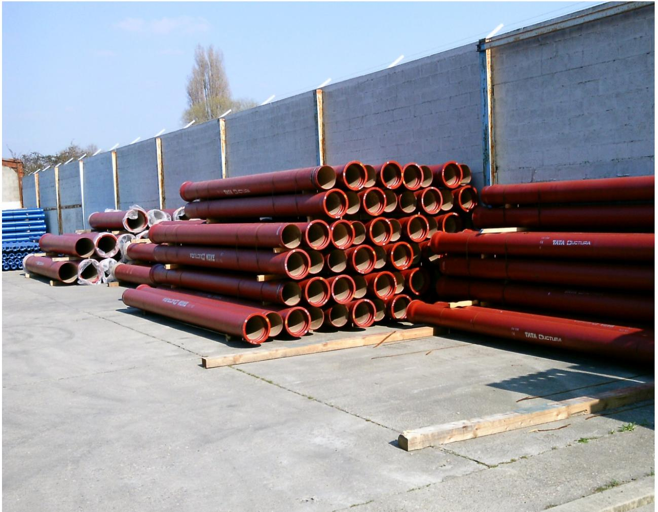
Chantier France : tuyaux C50 & C40, 23000 mt DN 100 à DN 500 mm (AEP/Assainissement)
