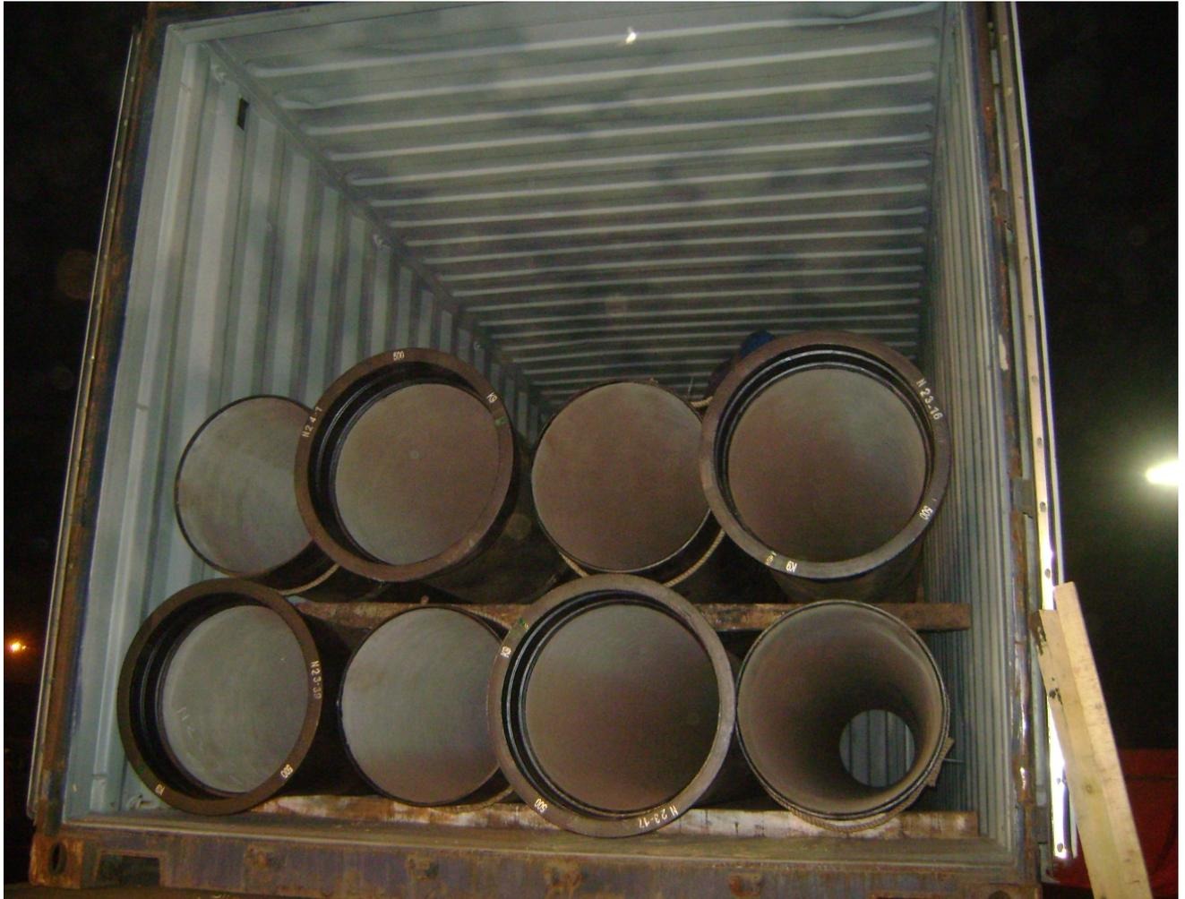
Chantier La Réunion : tuyaux K9, 7000 mt DN 350 & DN 400 mm (AEP/Eau brute)
